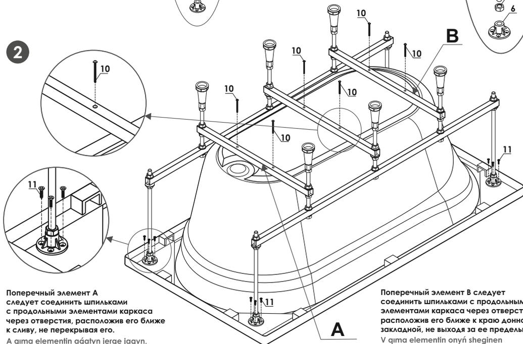
Поперечный элемент А следует соединить шпильками с продольными элементами каркаса через отверстия, расположив его ближе к сливу, не перекрывая его.
